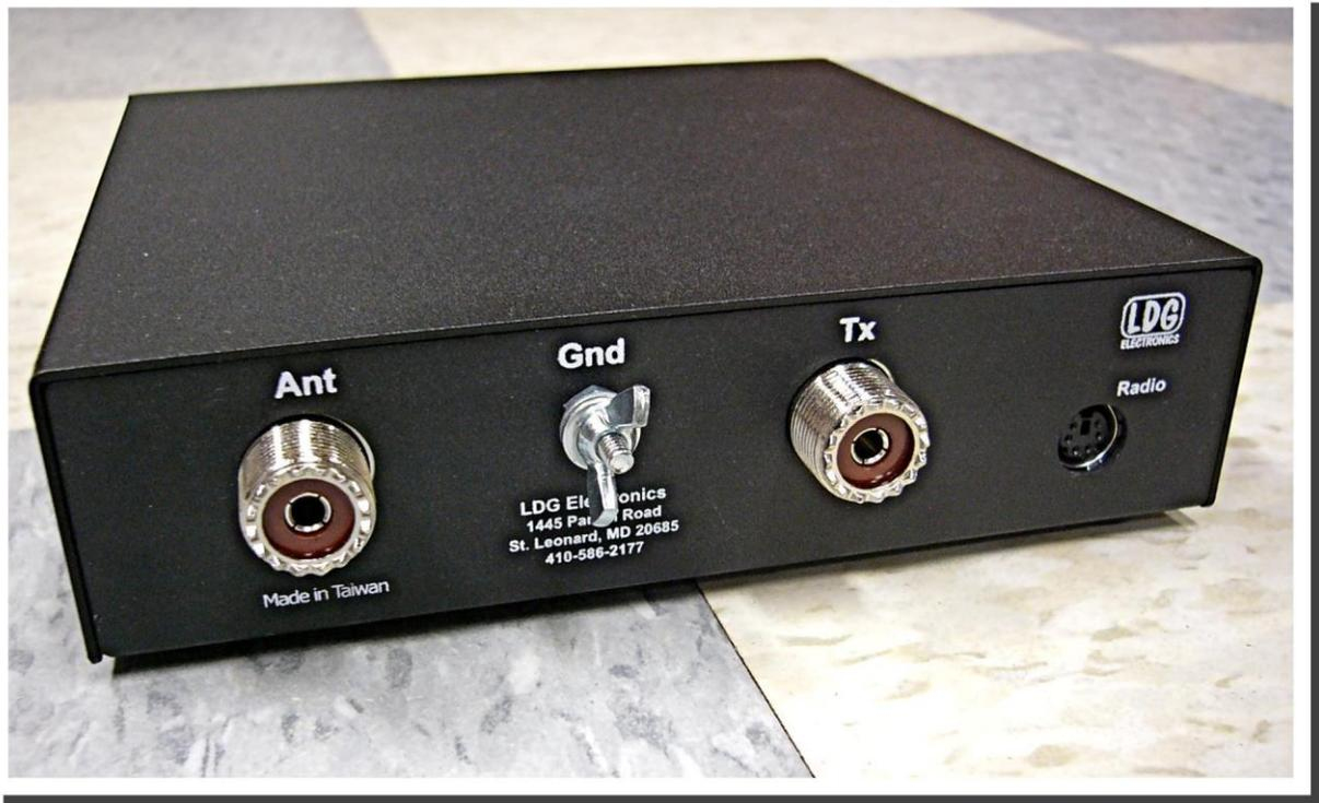
**Conector ANT:** Conecte el cable coaxial de 50 ohmios de la línea de alimentación del antena al conector standard SO-239
