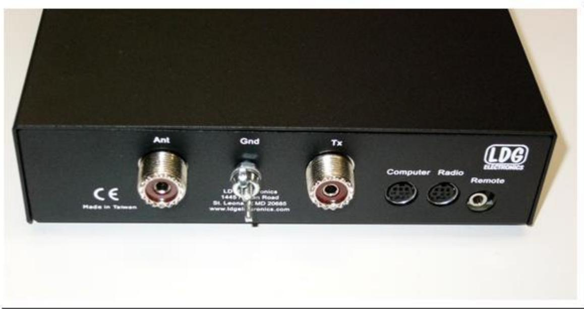
**Conector ANT:** Conecte el cable coaxial de 50 ohmios línea de alimentación a este conector estándar SO-239.
