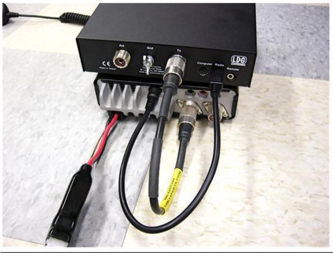
En la prensa FT-857/897, y mantenga el **FUNC** botón durante un segundo para activar el sistema del menú ampliado. Gire el **SEL** perilla hasta menú # 019 "TASA CAT" es visible. Gire la perilla de sintonía principal hasta que "4800bps" está mostrando. Debido a que el YT-100 es compatible tanto con el FT-857/897 y la serie FT-100 de transceptores, la tasa de CAT 4800 bps se deben utilizar para acomodar los mayores FT-100.
